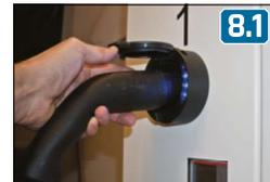
**8.1** Ladevorgang erfolgreich abgeschlossen. Anschließend das Ladekabel aus der Fahrzeugbuchse ziehen. Alternativ/Zusätzlich: Das Ladekabel aus der Steckdose am Terminal ziehen.
